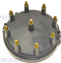
E64-0009 TÊTE DE DELCO Volvo/OMC5.0/5.8l (94-97) OMC/Volvo3854217 Merc339-832757A4
